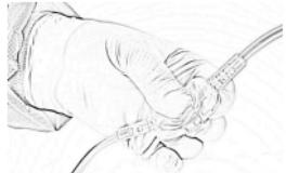
2. Attaccare il connettore femmina dello SMART BULB al sistema d'irrigazione.
