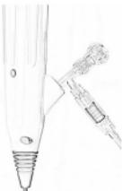
3. Przesuń niebieski suwak w stronę męskiego łącznika luer-lock aby zamknąć przepływ płynu lub przesuń suwak z powrotem aby otworzyć przepływ.
